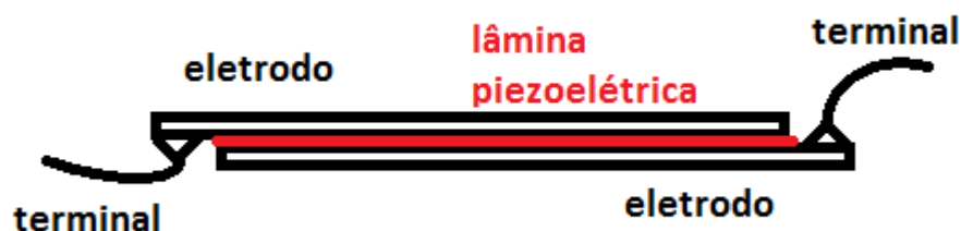
FIGURA 6 – Camadas do sensor piezoelétrico
